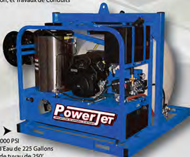
▶ PJCI1228D 12 GPM @ 2800 PSI Réservoir d'Eau de 325 Gallons Système de Filtration Dévidoir de Tuyau de 300' pour Boyau de Remplissage et Dévidoir de Boyau de 500' pour Boyau de Jetter Guides d'Enrouleur de Boyau et Commande à Pédale Inclus Conçu pour une Mine pour le Jetting de Tuyau, Tuyau D'Évacuation, et Travaux de Conduits
